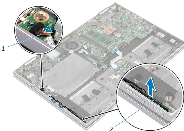
1 cable de la placa de los botones de encendido y volumen
